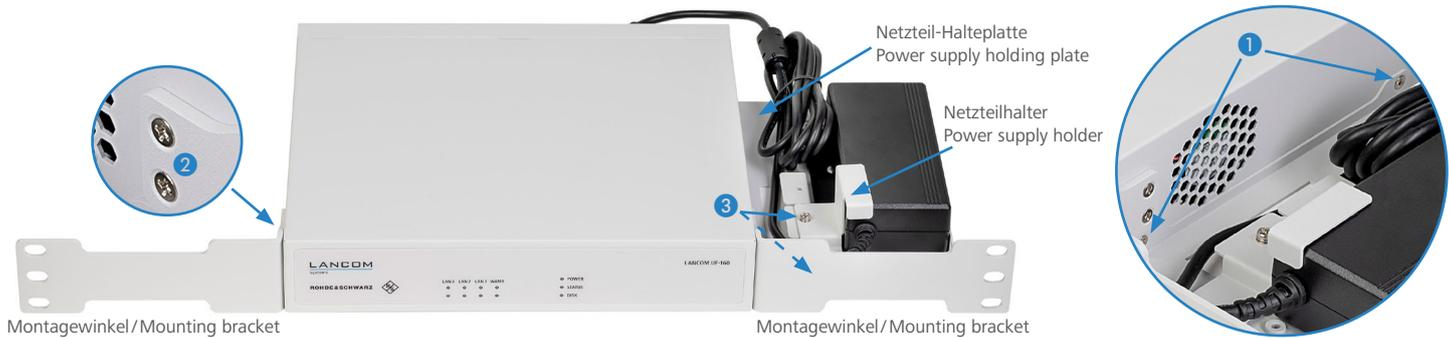
Beginnen Sie mit der Montage der Netzteil-Halteplatte, indem Sie auf der rechten Geräteseite die unteren beiden Gehäuseschrauben **1** aus dem Gerät entfernen.
